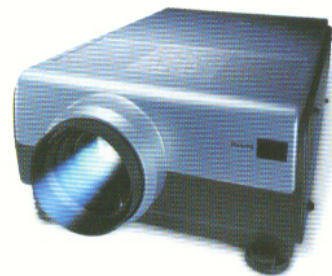
Cañón de proyección multimedia. Tiene la capacidad de proyectar imágenes generadas en la computadora o desde una videograbadora o un lector de DVD.
