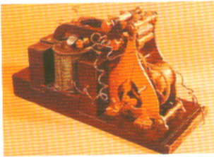
Telégrafo con el que Morse transmitió el primer mensaje telegráfico.
